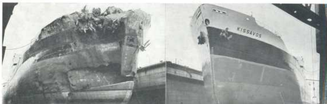
Een „kopschade“ voor . . . en na behandeling op de R.D.M.
