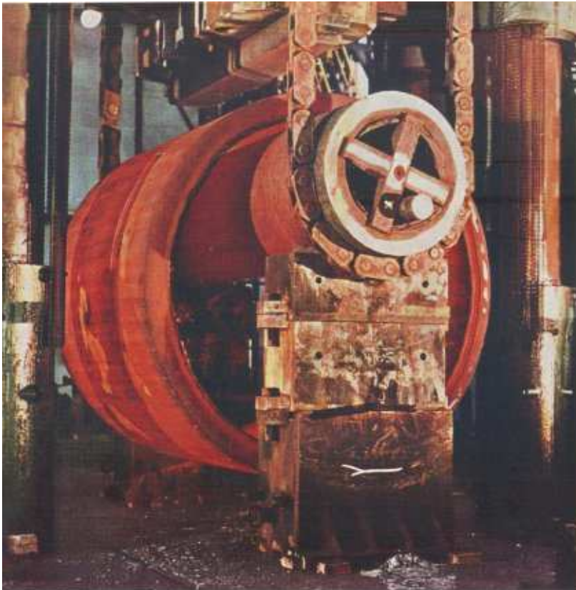
Smeedwerk voor een kernreactor. De smederij van de R.D.M. behoort tot de groten van Europa.
