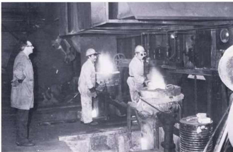
Twee kroesovens waarin koper, bronslegeringen of aluminium gesmolten wordt.
